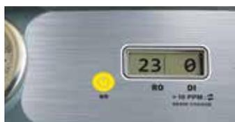
Il **misuratore TDS** mostra la qualità dell'acqua dietro le membrane RO e dietro il filtro a resina DI. Le membrane (RO) dovrebbero funzionare al 95-98% di efficienza rispetto all'acqua di rubinetto.
