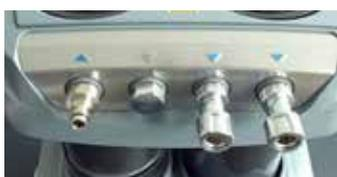
Nel lato anteriore sono presenti tre attacchi per le aste di pulizia e un attacco per l'alimentazione dell'acqua. Sono attacchi per tubi flessibili standard.
